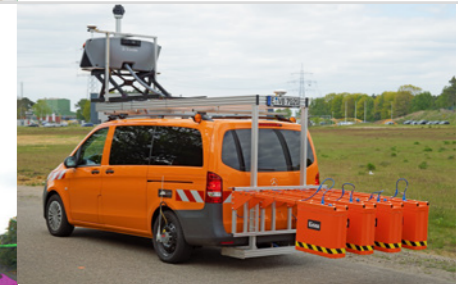
> oben: Essener Messfahrzeug mit Laserscanner Aufbau (oben) und Georadarantennen (hinten)
